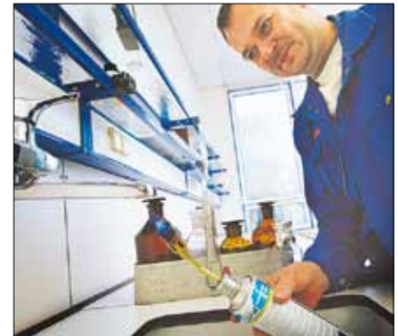
Vor der Probenentnahme an „Wasserhähnen“ werden die Armaturen abgeflammt, damit keine äußeren Verunreinigungen in das zu untersuchende Wasser gelangen können.
