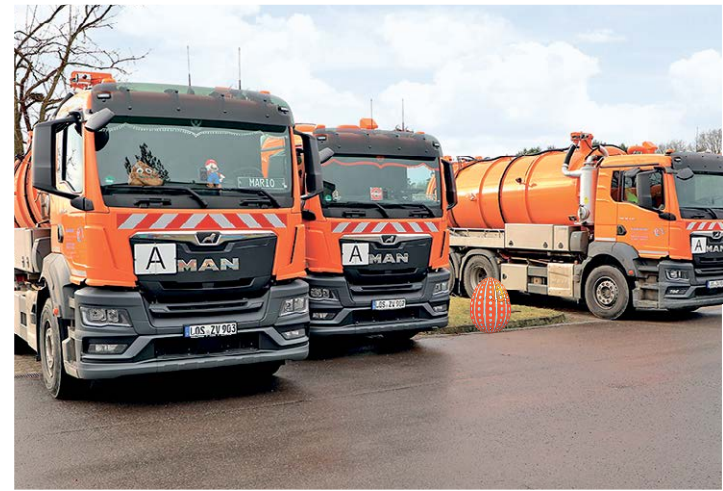
Insgesamt 14 dieser neuen Saugfahrzeuge kommen bei der dezentralen Entsorgung zum Einsatz. Foto: SPREE-PR/kk
