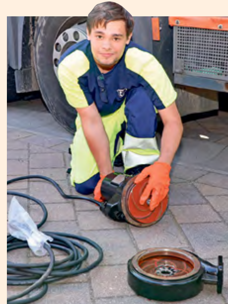
Azubi Tim Elias Eltz darf von Anfang an mitanpacken. Hier beim Auseinanderbauen einer Abwasserpumpe.
