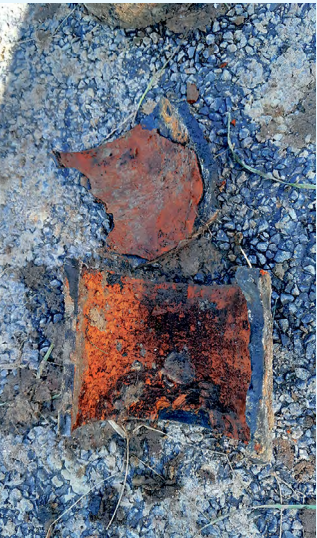
Teile des durch Korrosion gebrochenen und zerfallenen Gussrohrs der Trinkwasserleitung Jänickendorf.
