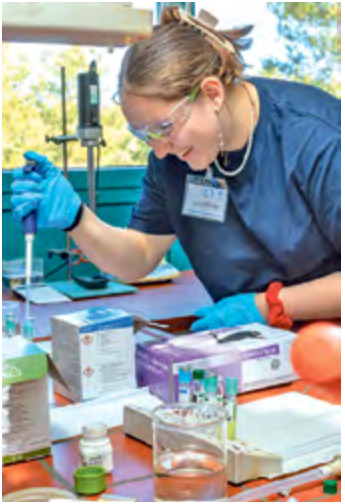
Josefine führt einen Kuvettentest durch, wie er im Labor der Kläranlage zur Analyse des Abwassers eingesetzt wird.
