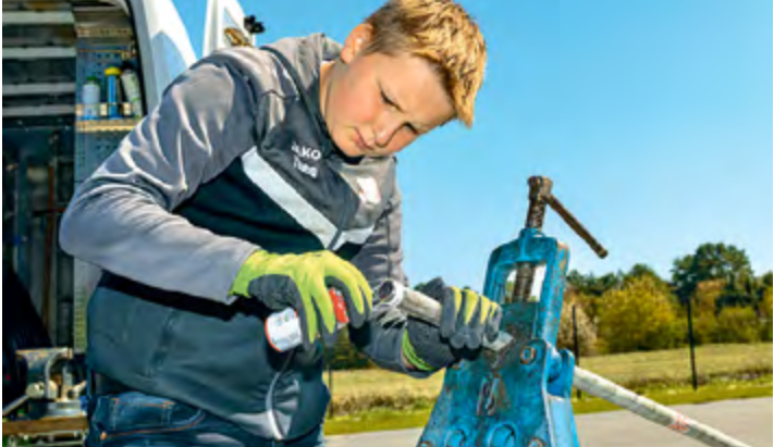
Theodor hanft ein Gewinde ein und dichtet es damit ab.
